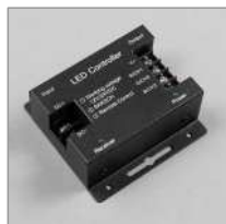
LED receiver RGB 3 channel moduł sterujący LED RGB 3-kanałowy 12V/24VDC; 216W/432W
